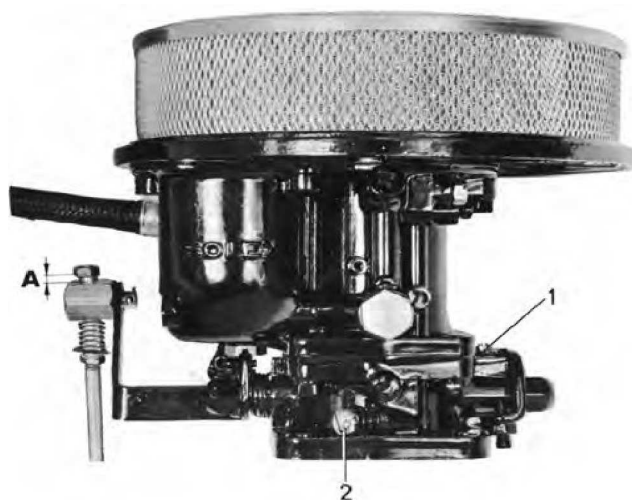
Fig. F9. Single carburetor Solex (AQ115A)
